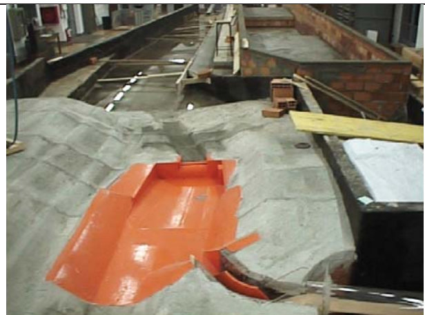
Manufatto di restituzione e dissipazione in Val Clarea
